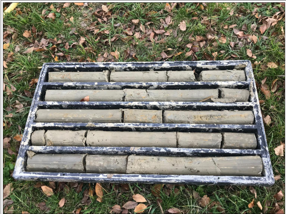
Foto n° 6 - Cassetta catalogatrice C5, profondità' 20,0 m - 25,0 m
