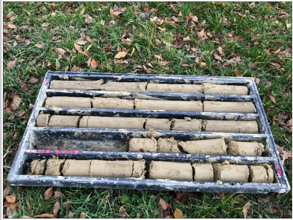
Foto n° 3 - Cassetta catalogatrice C2, profondità' 5,0 m - 10,0 m
