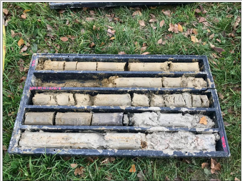
Foto n° 4 - Cassetta catalogatrice C3, profondità' 10,0 m - 15,0 m
