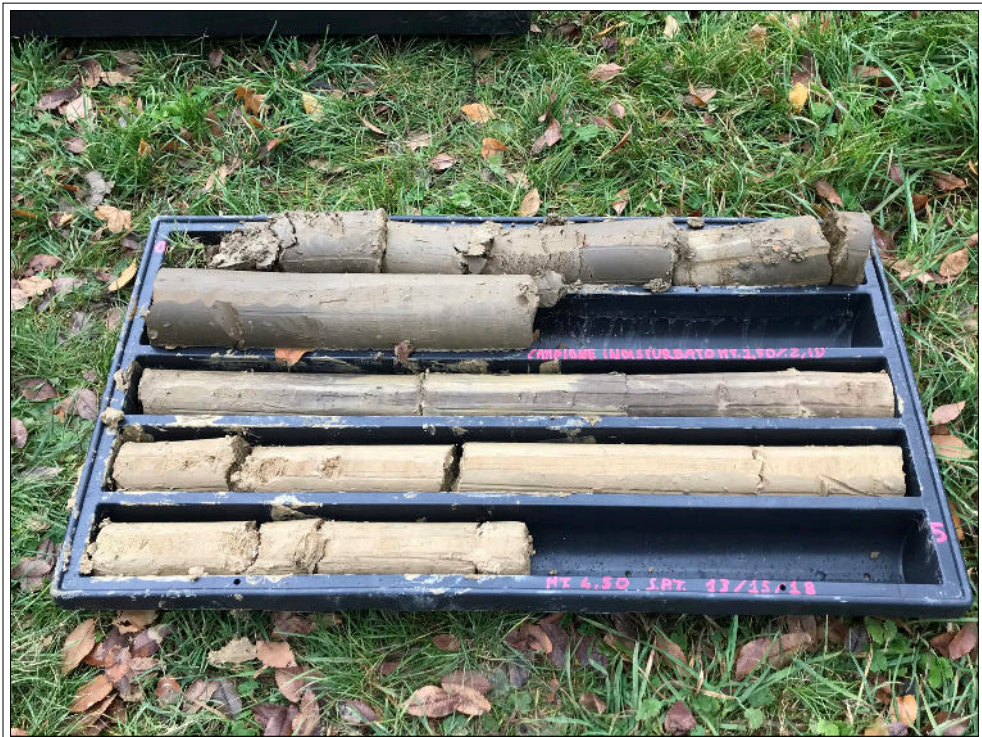
Foto n° 2 - Cassetta catalogatrice C1, profondità' 0,0 m - 5,0 m
