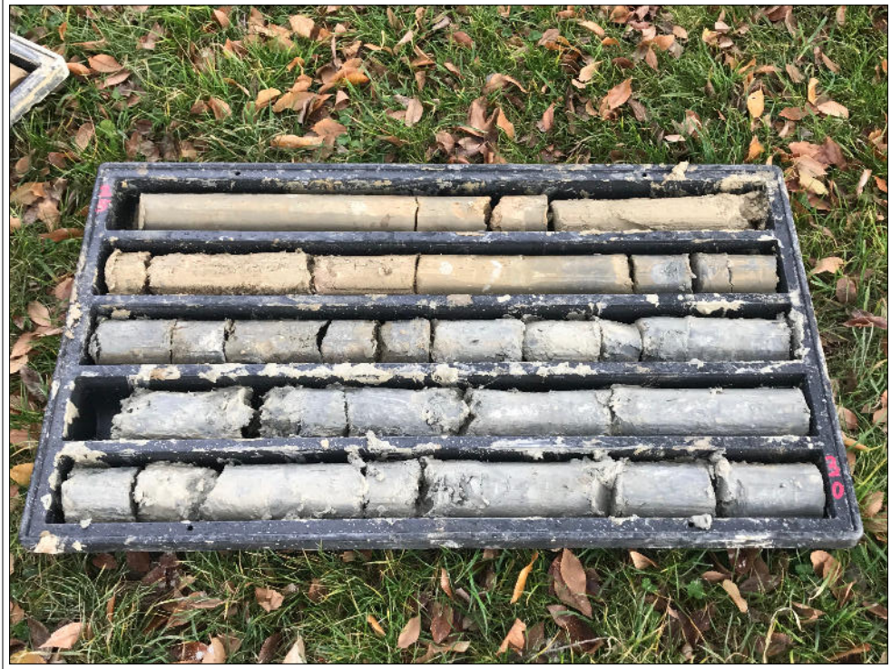
Foto n° 7 - Cassetta catalogatrice C6, profondità' 25,0 m - 30,0 m
