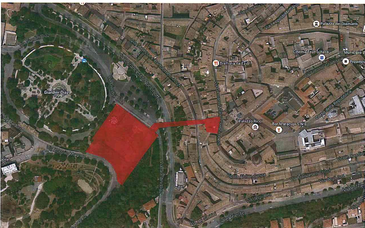
estratto aereo dell'area; in rosso l'ingombro del parcheggio, del tunnel meccanizzato e l'uscita all'interno del Centro Storico di Macerata
